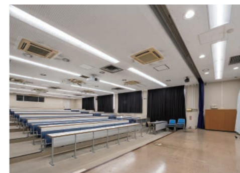
大教室 TENQOOシリーズ埋込形の連結用器具③を採用し3台連結して配置。
