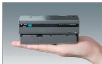
R7シリーズは、少点数に適した入出力一体形のリモートI/Oです。すっぽり手のひらに収まるコンパクトなハウジングに入出力部・通信部・電源部を納めた、気軽に、また安全にご使用いただけるオールインワン構造のリモートI/Oです。
