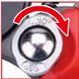
0.14mm (AWG26)～10mm (AWG6) までの電線を圧着する際にはノブを“10”の位置。16mm (AWG5) を圧着する際には“16”の位置に切替えてご使用ください。
