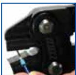
TA-210なら、0.08mmの電線を0.14mm、0.25mm、及び0.34mm用のフェルールで圧着する事ができます。板状に圧着する機構により、極細電線でも均一性のある圧着品質が得られるようになっています。
